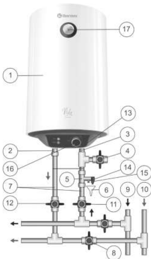
Рисунок 1. Схема підключення ЄВН до водопроводу
